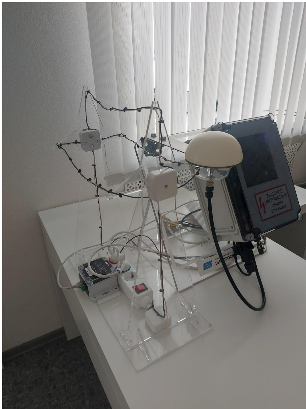
Рисунок Г.1. Лабораторный стенд для испытания датчика ISL
